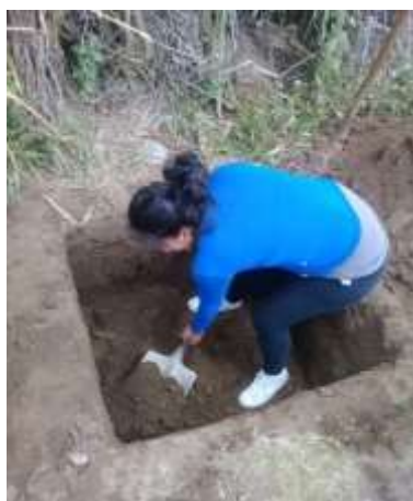
Figura 22. Pozo a cielo abierto de 1 metro cúbico
