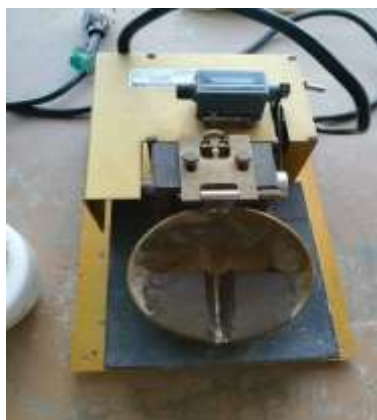
Figura 83. Muestra de suelo dividida con el ranurador
