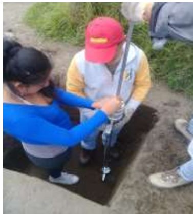
Figura 71. Ejecución de los golpes para el DCP
