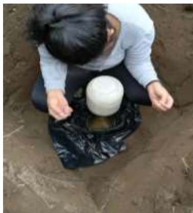
Figura 75. Colocación de la Arena de Ottawa en la cavidad en el suelo
