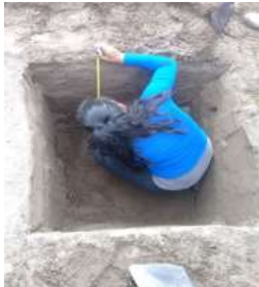
Figura 68. Medición del pozo a cielo abierto Autor: Paulina Mishell Altamirano Coro
