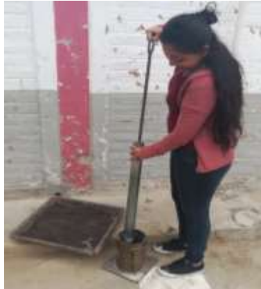
Figura 90. Compactación de la muestra de suelo molde 27 golpes
