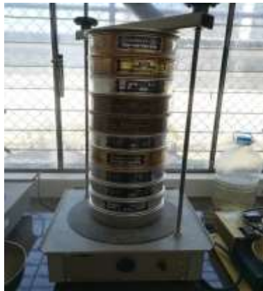
Figura 80. Tamizado de la muestra durante 15 minutos.
