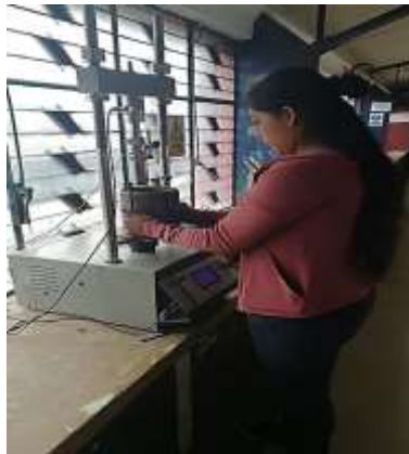
Figura 91. Colocación del molde en la Máquina de CBR
