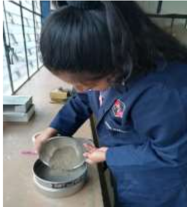
Figura 84. Muestra tamizada por Tamiz #40
