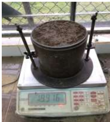
Figura 89. Pesado de la muestra luego de ser compactada y enrazada
