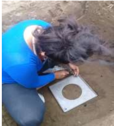
Figura 73. Colocación de la placa metálica
