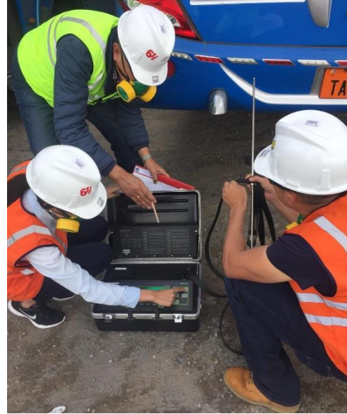
Figura 5. Preparación de Analizador ECA 450
