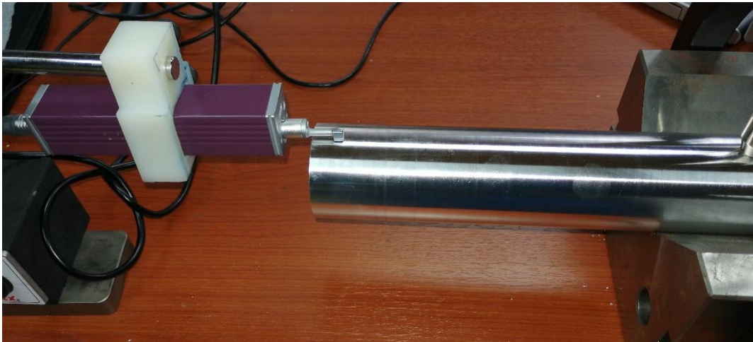
Figura 26. Ensayo de rugosidad superficial en eje de AA 7075-T6.
