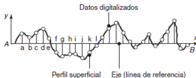
Figura 9. Coordenadas para la medición de rugosidad superficial [27].
