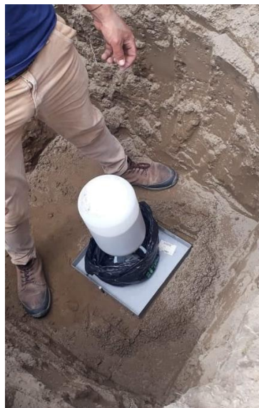
Figura 26. Ensayo con cono y arena de Ottawa Fuente: Esteban Wladimir Tenecota Paredes
