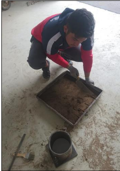
Figura 31. Ensayo Proctor Modificado Fuente: Esteban Wladimir Tenecota Paredes
