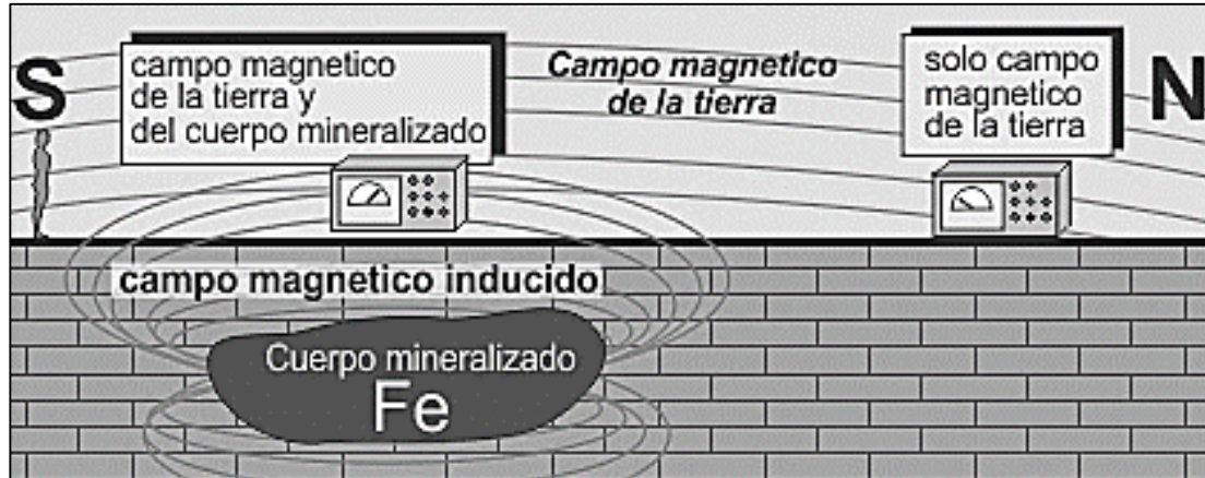
Figura 12. Método magnético Fuente: GeoVirtual, 2013
