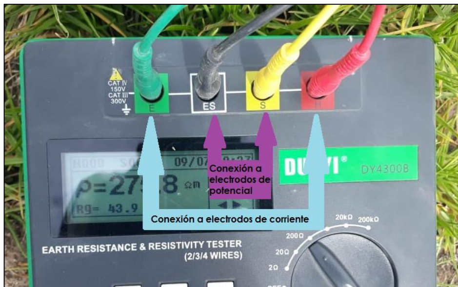
Figura 24. Cableado en el telurómetro Fuente: Esteban Wladimir Tenecota Paredes
