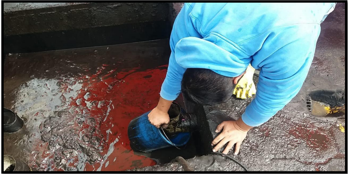
Figura 13 Medición de volumen método volumétrico fuente: Carlos Pinto – Edwin Villacis
