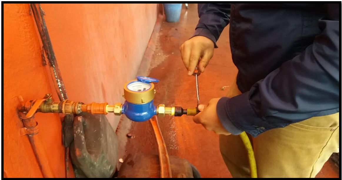
Figura 12 Medición de volumen con medidor de agua fuente: Carlos Pinto – Edwin Villacis
