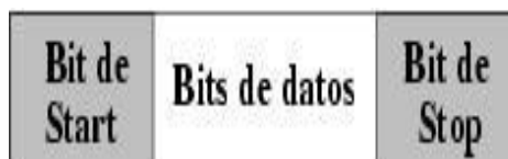
Figura 2.28. Comunicación serie asíncrona.
