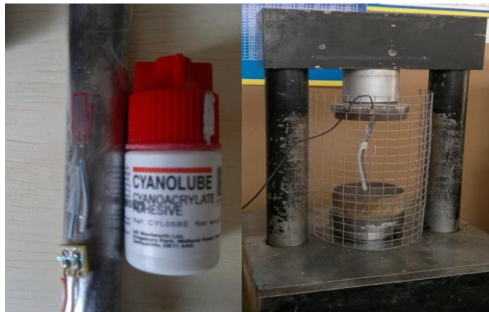
Figura 4.6. Pegado de la galga en la probeta de acero AISI 1018 y ejecución de pruebas de compresión.
