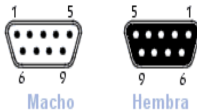
Figura 2.31. Conector DB9, numeración de pines macho y hembra.
