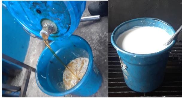
Figura 2.25 Preparación de la Taladrina
