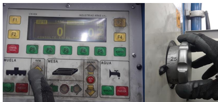
Figura 2.27 Marcación de las velocidades y profundidad de pasada
