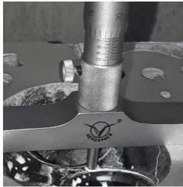
Figura 2.34 Medición de la profundidad rectificada
