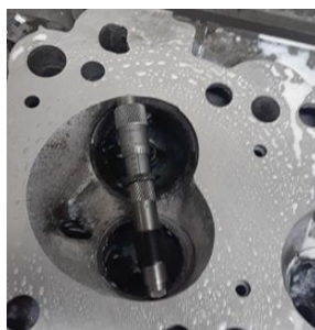
Figura 2.32 Verificación del diámetro de la cámara de combustión
