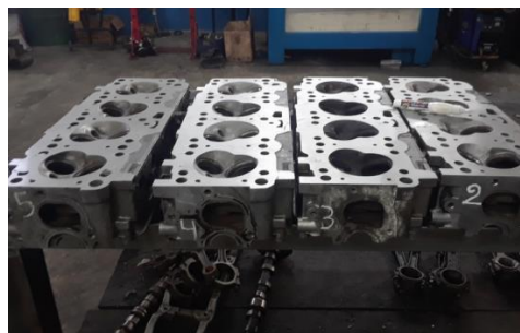
Figura 2.21 Limpieza de los cabezotes de aluminio a ser ensayadas.
