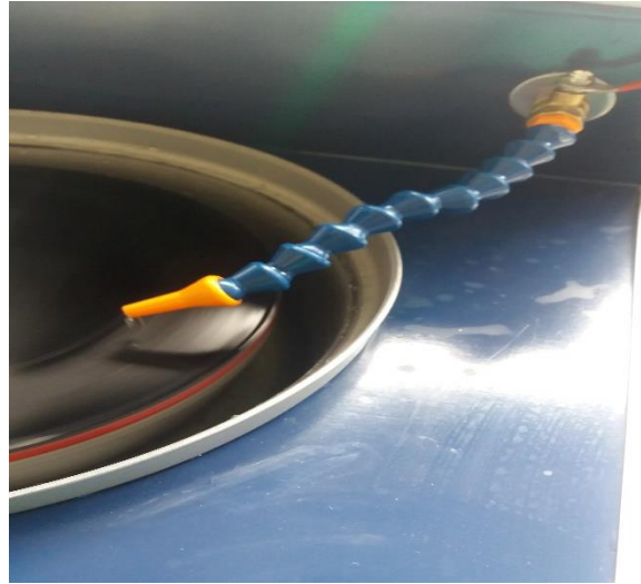
Figura 3.27: Sistema de refrigeración.
