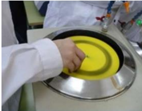
Figura 1.5: Pulido final de una probeta [13].
