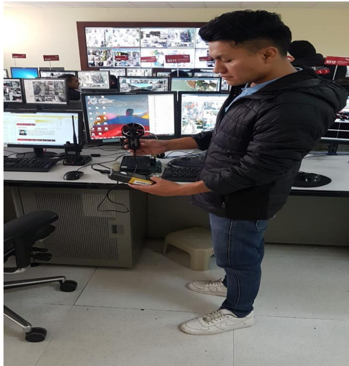
Fig. 11 Medición de la velocidad del aire en los puestos de trabajo del ECU 911
