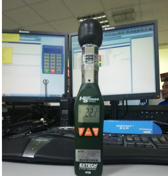
Fig. 10 Medición de la temperatura ambiente en los puestos de trabajo del ECU911.
