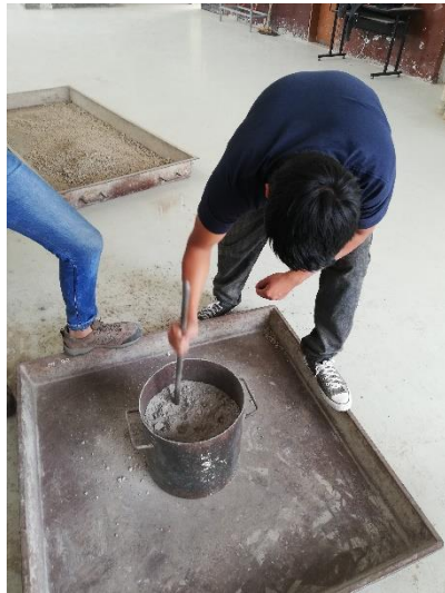
Proceso de compactación por capas y golpes.
