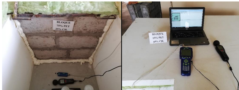
Ilustración 31. Ensayo acústico de paredes.
