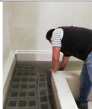
Curado de los bloques.
