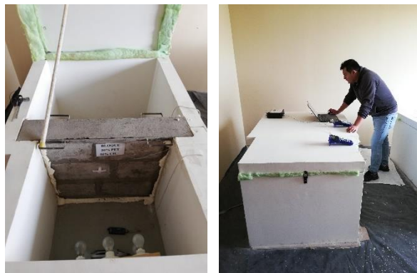
Ilustración 29. Ensayo térmico de paredes.
