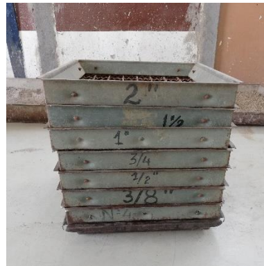
Ilustración 10. Granulometría del agregado grueso.
