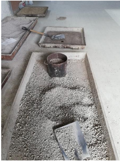
Inicio del ensayo solo con agregado grueso.
