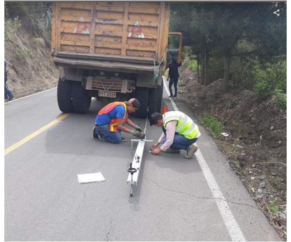
Calibración de la viga benkelman
