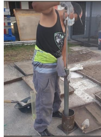
Ensayo Proctor modificado
