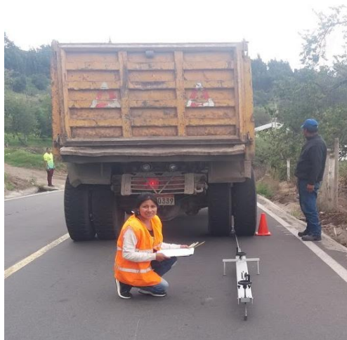
Ensayo con la viga Benkelman
