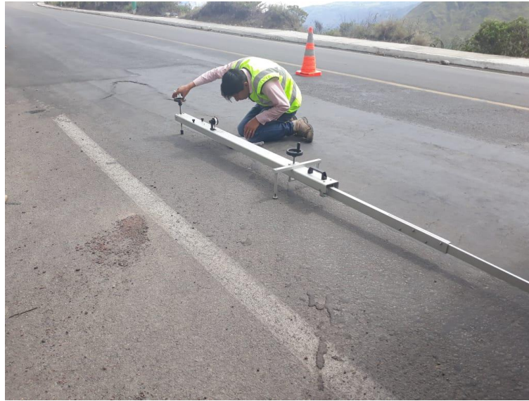
Figura 51. Ensayo viga Benkelman
