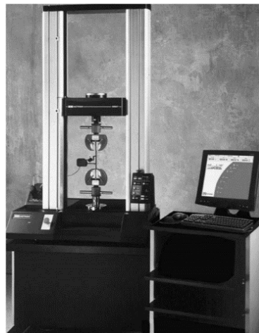
Figura 2. 4 Máquina moderna para ensayos de tracción [7].
