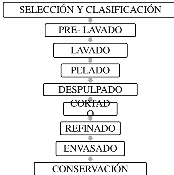
Figura 3-1 Proceso de despulpado para maracuyá, taxo, guanábana, tamarindo, piña de la empresa Productos Suiza Dajed Cia. Ltda.
