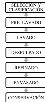
Fig. 3. Proceso de despulpado para mora, tomate, naranjilla, fresa, papaya, guayaba.
