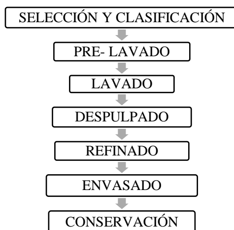
Figura 3-2 Proceso de despulpado para mora, tomate, naranja, fresa, papaya, guayaba de la empresa Productos Suiza Dajed Cia. Ltda.
