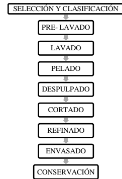
Fig. 2. Proceso de despulpado para maracuyá, taxo, guanábana, tamarindo, piña.
