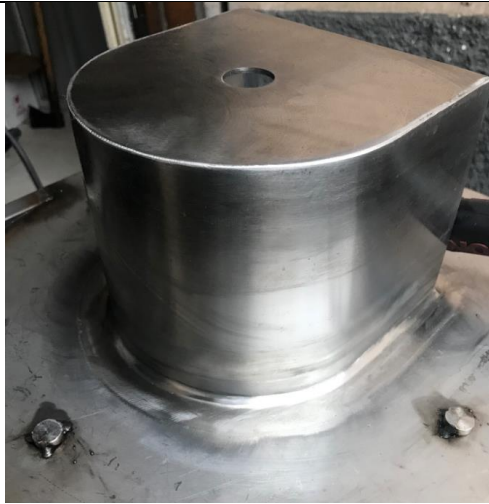
SOLDADURA DEL TAMIZ
