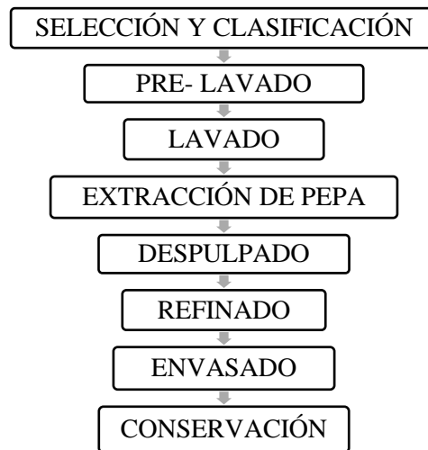
Figura 3-3 Proceso de despulpado para mango de la empresa Productos Suiza Dajed Cia. Ltda.
