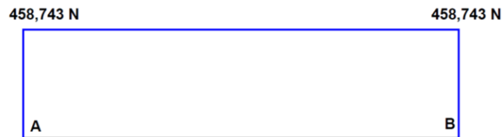
Figura 3-15 Diagrama de fuerza cortante de la cuchilla.
