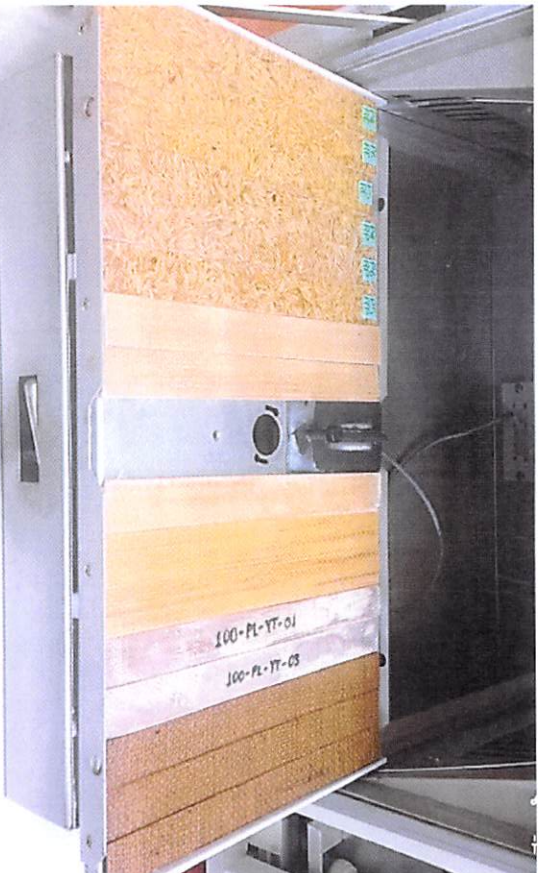
Fotografía No. 2: Muestras antes de ser ensayadas en la cámara de xenón
