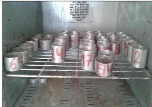
Muestra para en ensayo limite líquido y limite plástico
