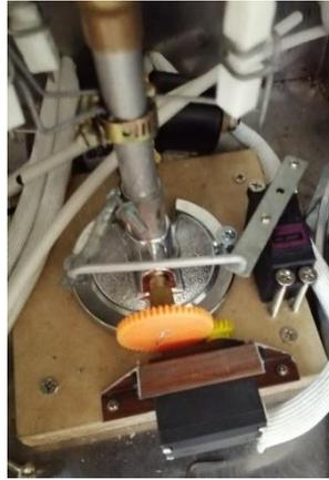
**Figura 3.1.18:** Adaptación de los servomotores al mechero.
