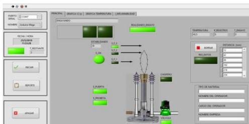
17.- Activación automática de la tapa del mechero. Cuando el contador de los 12 segundos finalice se activará un servo motor que tapara el mechero con el fin de evitar la caída de residuos en el interior de este.
