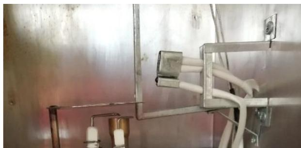
**Figura 3.1.23:** Ubicación de los sensores de flama.
