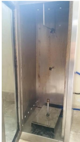
**Figura 3.1.15:** Estado inicial de la cámara de ensayo de inflamabilidad vertical.
