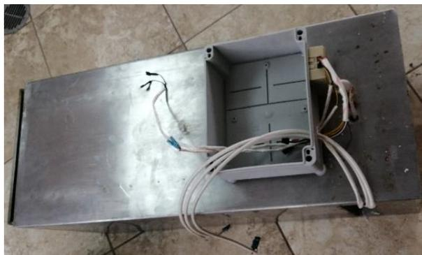
**Figura 3.1.21:** Instalación de la caja de PVC.
