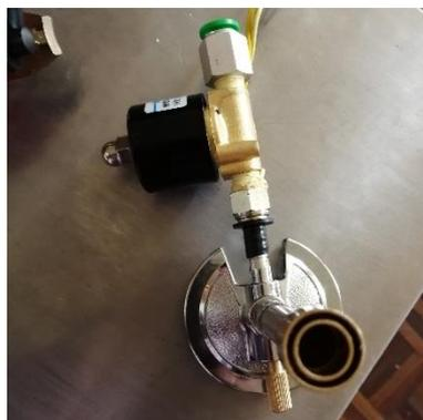
**Figura 3.1.17:** Conexión de la válvula solenoide al mechero.
