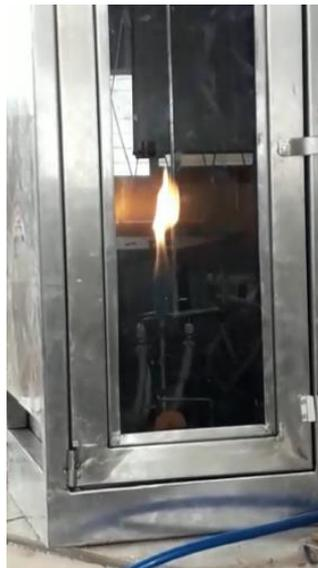
**Figura 3.1.4:** Prueba de funcionamiento de la cámara de inflamabilidad vertical.
