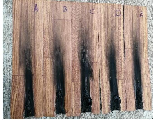
**Material compuesto de fibra de vidrio y resina poliéster**
