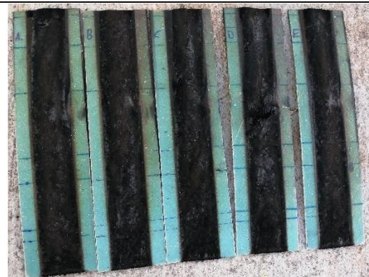
**Material compuesto de fibra de vidrio, textil y resina poliéster**
