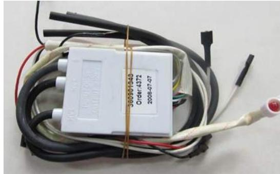
**Figura 3.1.6:** Módulo con las bujías de encendido de calefón.
