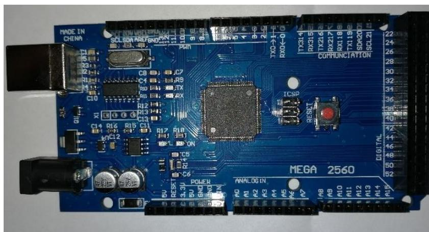
**Figura 1.3.7:** Placa de Arduino MEGA 2560.
