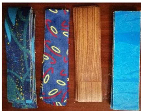
**Figura 3.2.1:** Probetas de: forro de esponja para asientos, pranna azul, vinil para piso y fibra de vidrio con una protección de pintura azul.
