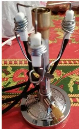
**Figura 3.1.19:** Instalación del chispero en el mechero.
