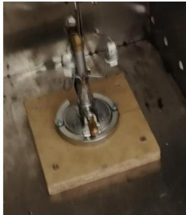
**Figura 3.1.16:** Quemador bunsen sobre la base de madera.
