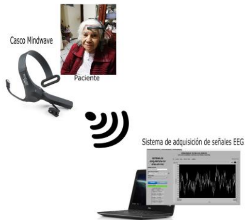
Fig. 17: Esquema del diseño general del sistema de detección de señales EEG
