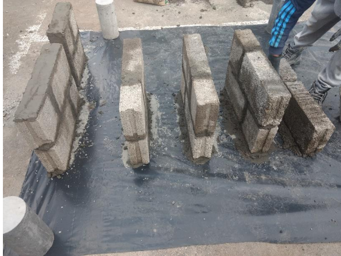
Figura 81: Elaboración de las muestras de mampostería.
