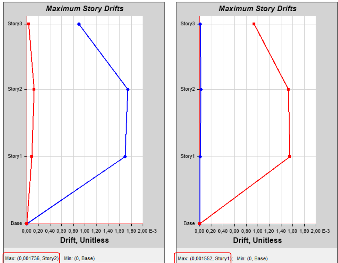
Figura 42. Derivas elásticas del Espectro Determinista en el sentido X e Y estructura de 2 pisos.
