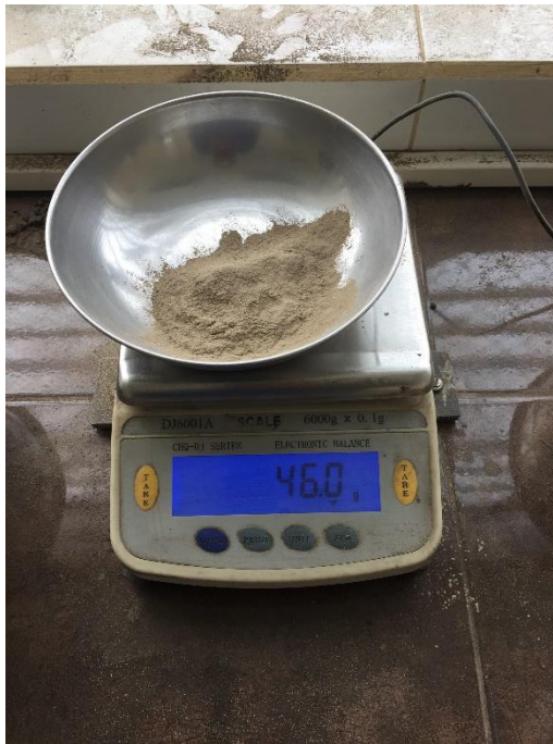
Fotografía 7: Obtención de pesos del suelo en los diferentes estratos.
