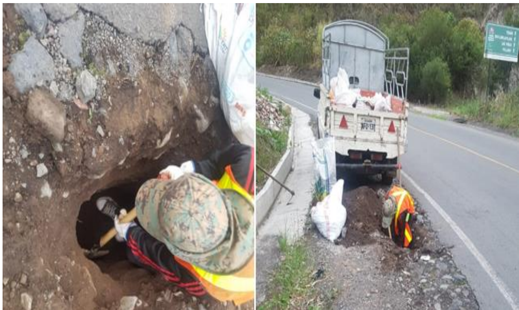
Gráfico 18: Extracción de muestras de suelo Fuente: Tixe Edison
