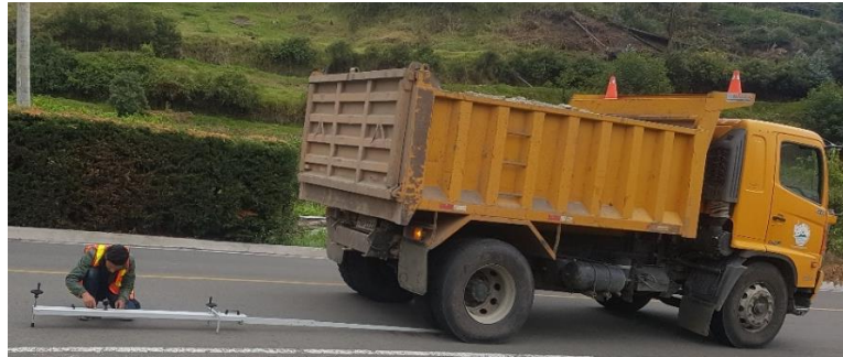
Gráfico 4: Evaluación estructural de un pavimento flexible mediante la Viga Benkelman Elaborado por: Tixe Edison
