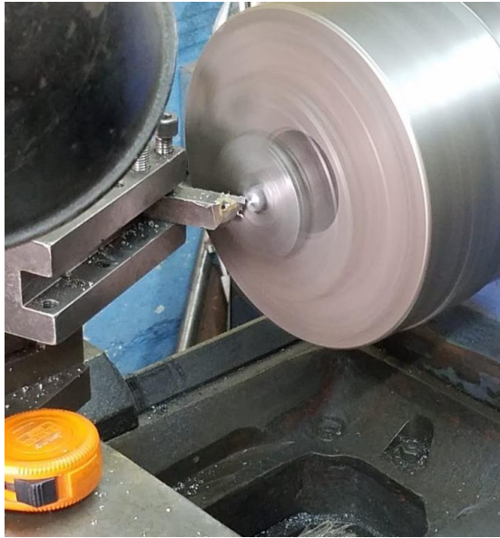
Figura 23. Maquinado de probetas de impacto. [Autor]
