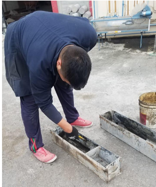
Figura 14. Preparación de moldes. [Autor]
