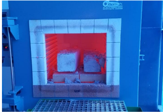
Figura 20. Horno a 950°C con probetas. [Autor]
