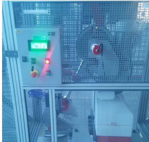
Figura 28. Ensayo de probeta de impacto. [Autor]
