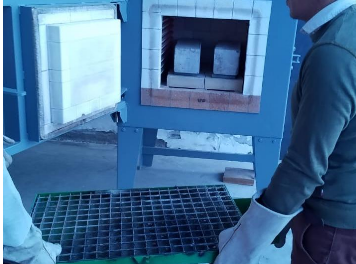
Figura 18. Horno a 650°C con probetas. [Autor]
