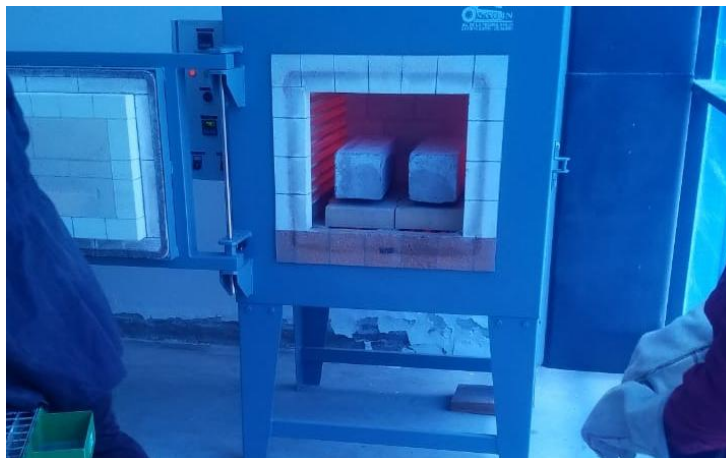
Figura 19. Horno a 650°C con probetas. [Autor]
