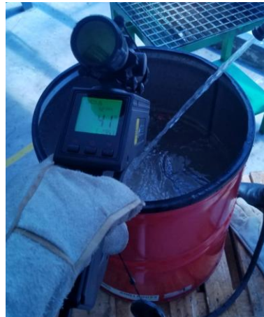
Figura 21. Enfriamiento de las probetas en el tanque [Autor]
