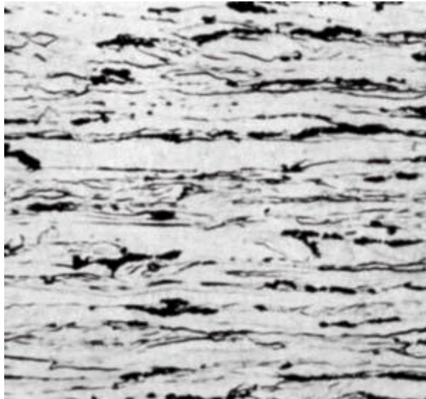
Figura 8. Acero AISI 1008, 1000X, 80% Reducción. [7]
