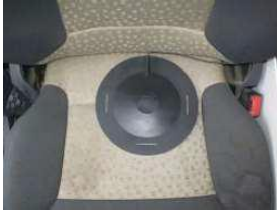
Fig. 4. Colocación de equipos de medición [48].
