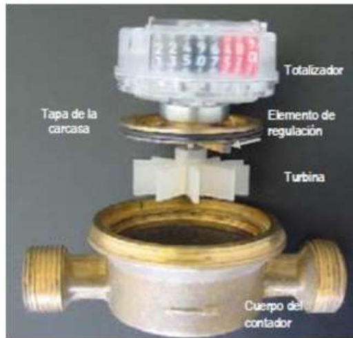
Figura 7: Despiece de un medidor de chorro único.
