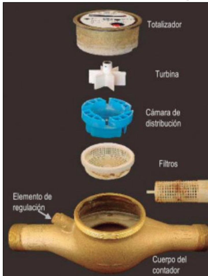
Figura 6: Mecanismo del medidor de chorro múltiple.
