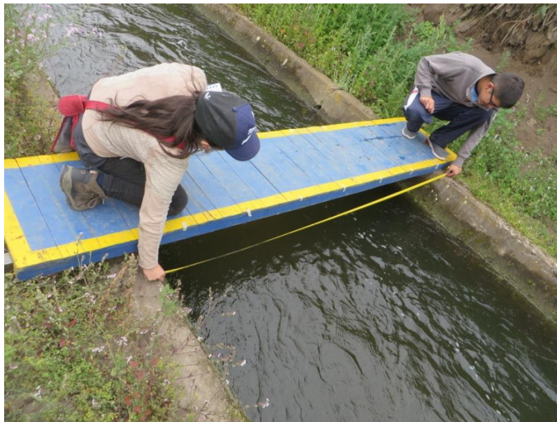
Fotografía 4.- Medición de los elementos geométricos de canal
