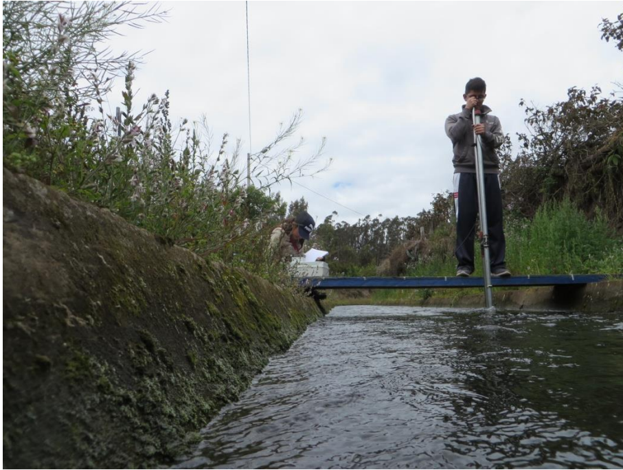
Fotografía 3.- Toma de muestras con el molinete
