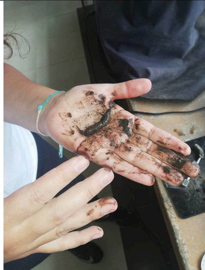
Formación de pastilla de material para el ensayo de límite plástico
