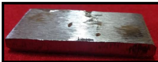
Figura 3-7: Probeta final previo a las limpiezas y la aplicación del recubrimiento. Fuente: Autor
