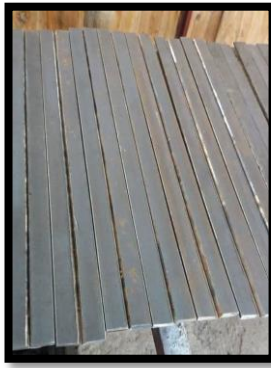
Figura 3-1: Platinas de acero A-36 de 6mm de espesor por 24 mm de ancho y 750 mm de largo. Fuente: Autor
