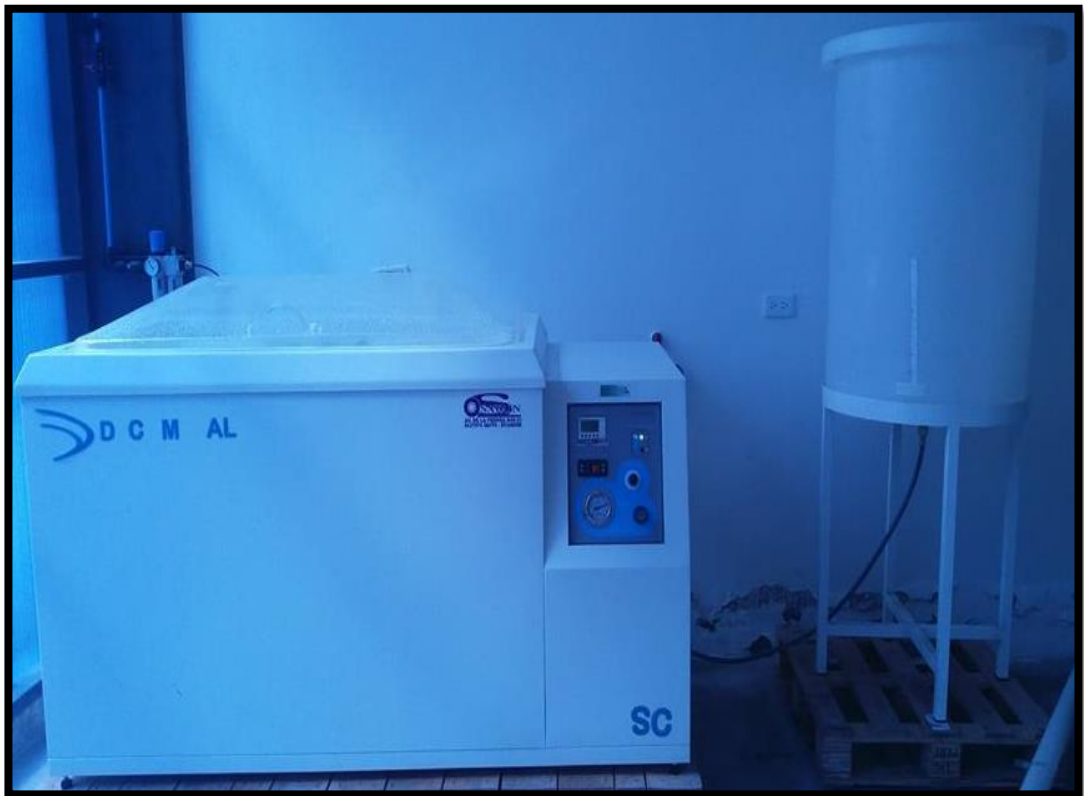
Figura 2-9: Cámara de Niebla Salina.
