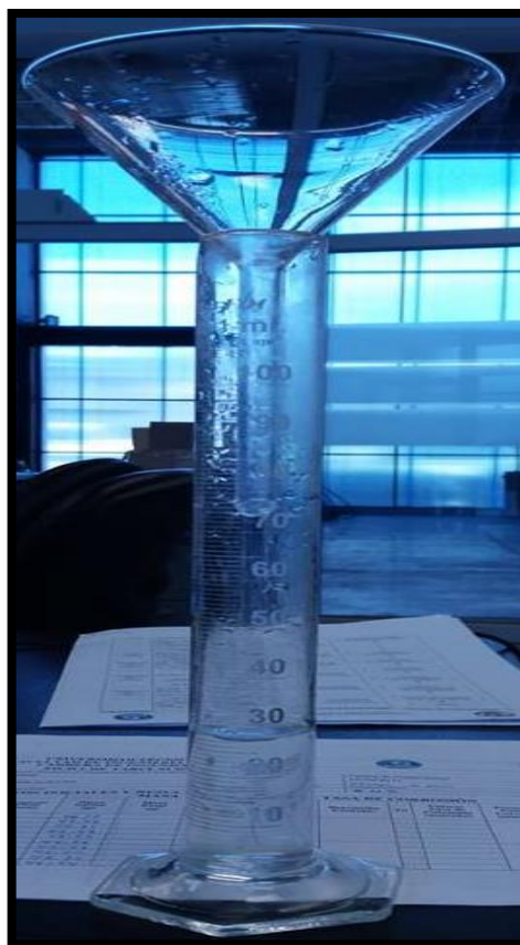
Figura 3-26: Fluviómetro con solución salina recolectada en el interior de la cámara durante el ensayo.
