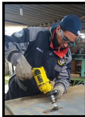
Figura 3-9: Limpieza mecánica con grata. Fuente: Autor
