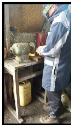
Figura 3-6: Remoción de la sobre monta de las probetas. Fuente: Autor
