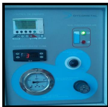
Figura 3-25: Sistema de control y regulación de la cámara de niebla salina.
