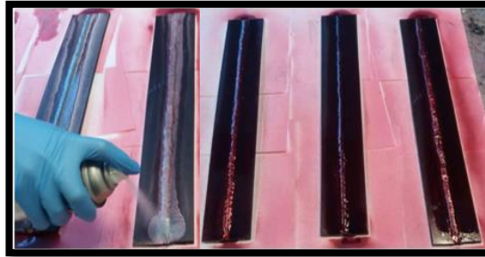
Figura 3-4: Ensayos no Destructivos a las platinas soldadas. Fuente: Autor
