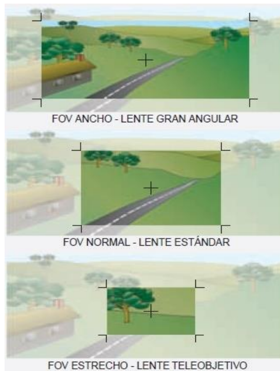
Gráfico 6.17. Campo de visión (FOV) con distintos tipos de lentes. (Fluke Corporation y The Snell Group, 2016)
