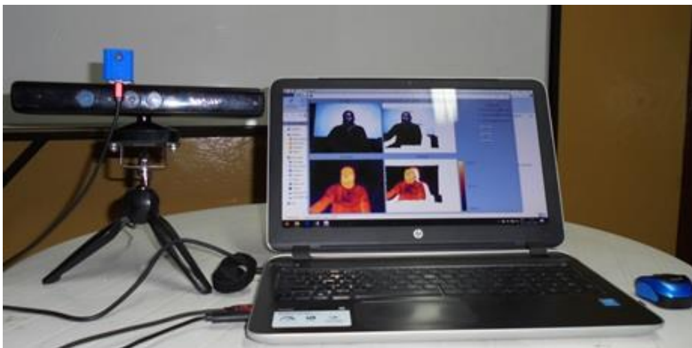
Gráfico 6.57. Integración del hardware y software sistema de control de termografía 3D. Elaborado por: El investigador.
