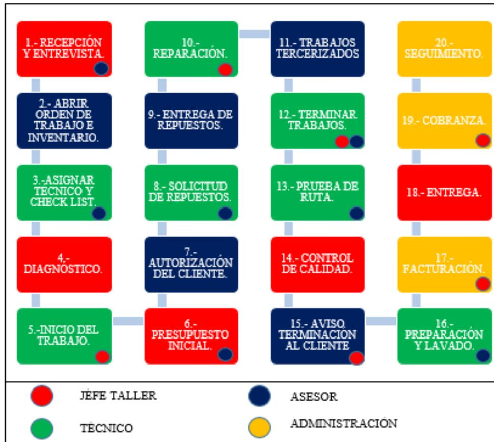
Fig. 7 Diagrama para Mantenimiento Vehicular
