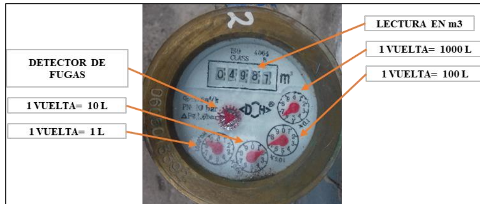
Figura 11: Lectura de típica de un medidor de agua potable Realizado por: Celso Sánchez Llamuca
