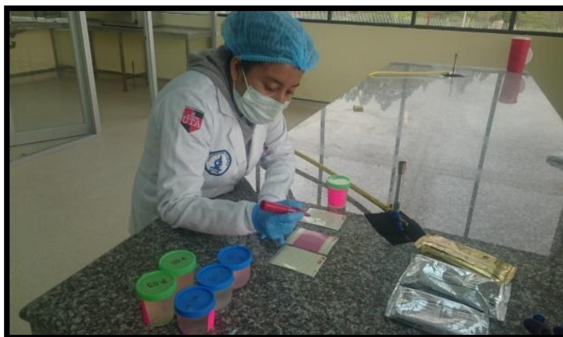
Fotografía 10: Siembra en las Placas 3M Petrifilm
