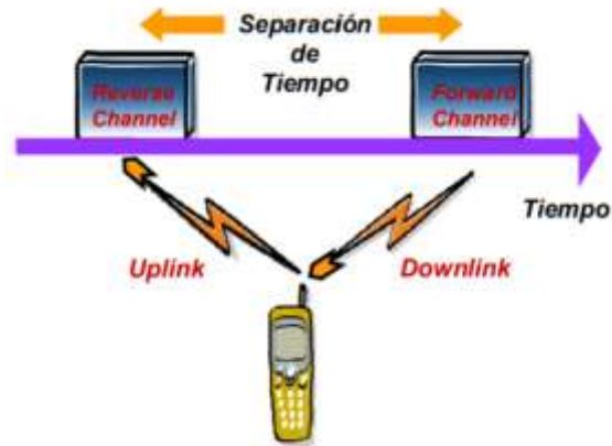
Figura. 2-12 DDT (Duplexacion por división de tiempo) [17]
