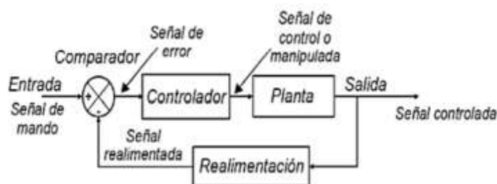
Figura. 2-10 Diagrama de bloque de un sistema en lazo cerrado [11]
