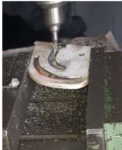
Figura. 6-8 Acople del soporte para graduar la antena. Fuente: Investigador
