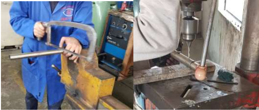
Figura. 6-7 Fabricación de soporte metálico Fuente: Investigador
