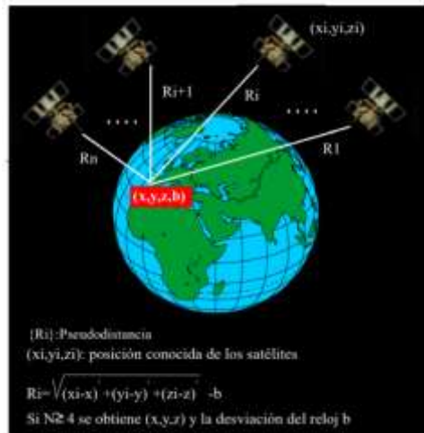
Figura. 2-23 Principio de funcionamiento del sistema GPS [22]
