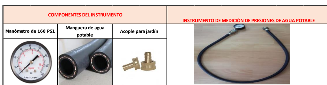
Figura 15: Instrumento de medición de presiones de agua potable. Realizado por: T.Llamuca
