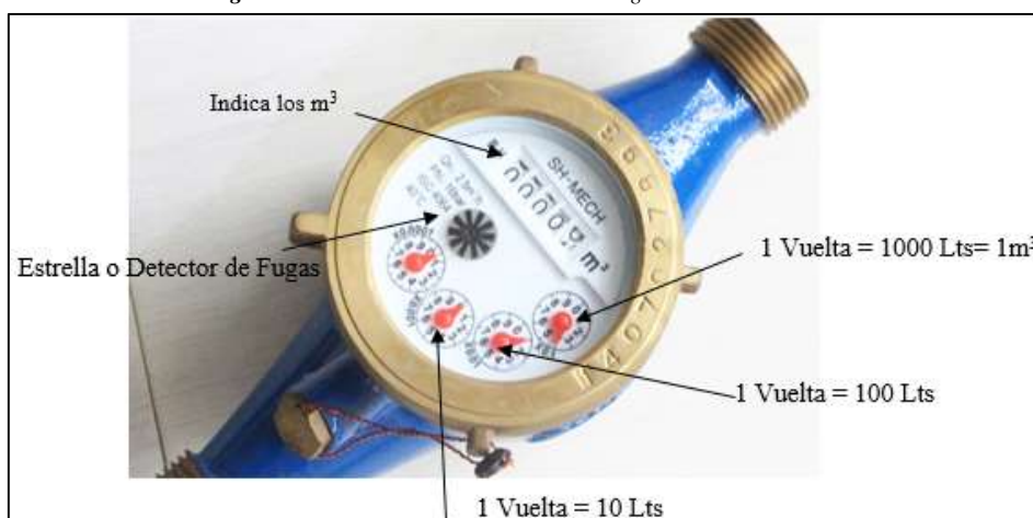
Figura 9: Como Leer un Micromedidor de Agua Potable
