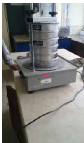
Fotografía 5. Tamización del suelo
