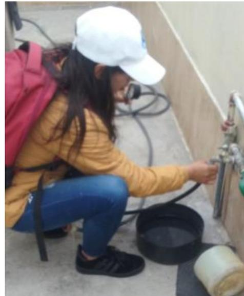
**Img 4.** Medición de la presión existente en la red de agua potable del sector.
