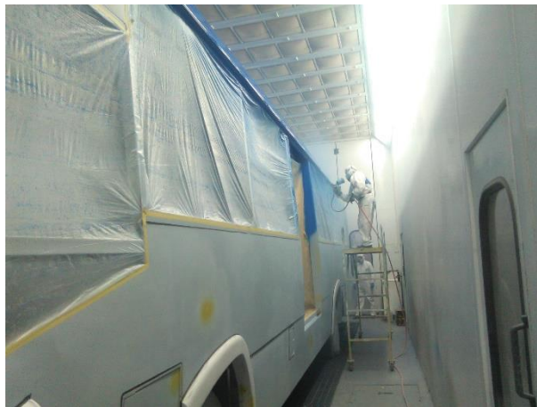
Figura 3.119 Personal calificado realizando el proceso de pintura al autobús
