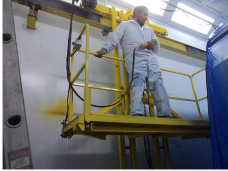
Figura 3.152 Persona destinada a realizar el proceso de pintura al autobús en el interior de la canasta de elevación, sujetándose a la estructura de la misma.
