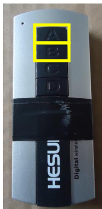
Figura 3.158 Presionar el botón deseado para su traslación y volver a oprimir el mismo botón para que se detenga el sistema
