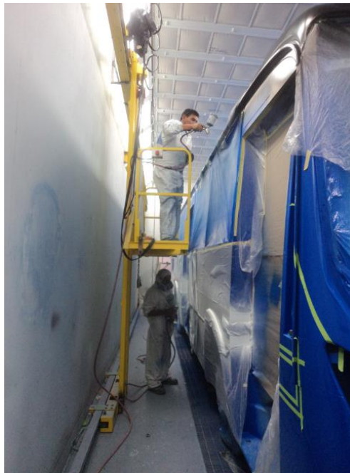
Figura 3.147 Personal designado a realizar el proceso de pintura al autobús, situado en el interior de la canasta de elevación elevada a una altura requerida.
