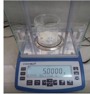
Figura 34. Pesado de harina para precipitación isoeléctrica.
