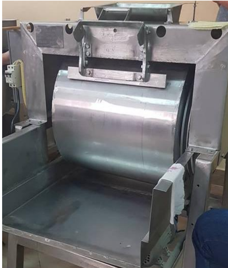
Figura C1. Tambor Rotatorio usado para la deshidratación de las papillas.
