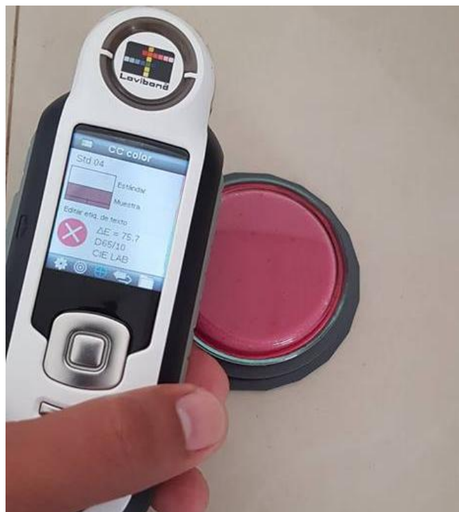
Figura C8. Medición de propiedades ópticas de papilla de mora.
