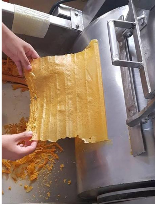
Figura C3. Secado de papilla de taxo en el secador de tambor rotatorio
