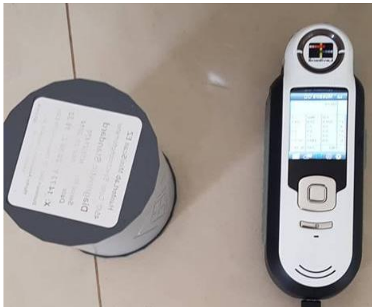
Figura C2. Colorímetro Lovibond RM-200.
