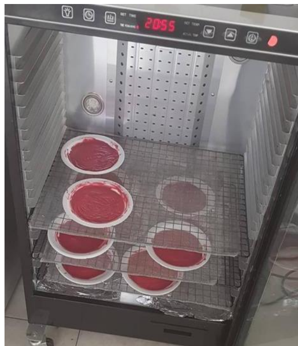
Figura C6. Secado de papilla en secador de aire caliente.
