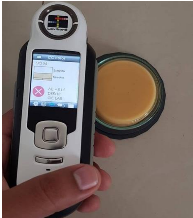
Figura C7. Medición de propiedades ópticas de papilla de taxo.
