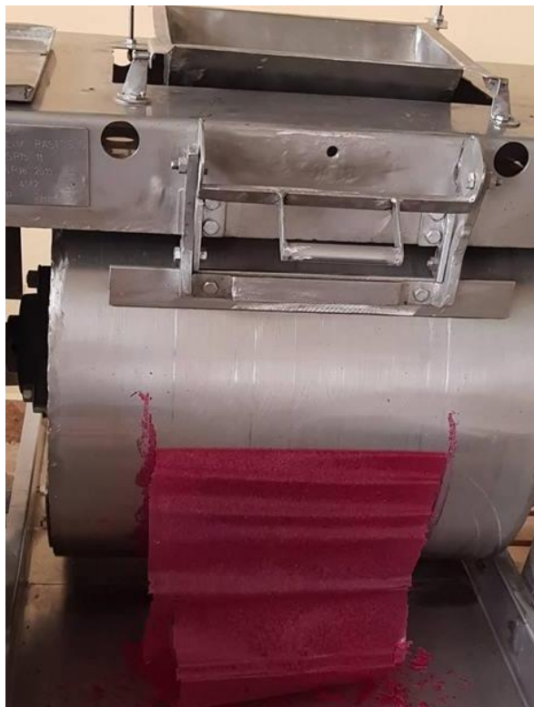
Figura C4. Secado de papilla de mora en el secador de tambor rotatorio
