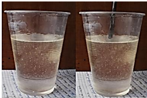
Figura 3. 14. Mescla de la resina epoxi con el endurecedor.
