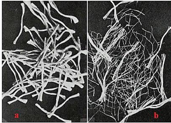
Figura 2. 21. (a) Fibras fibriladas de polipropileno manufacturadas en pequeños paquetes, (b) paquetes abiertos en fibras individuales para reforzar un material compuesto [14].
