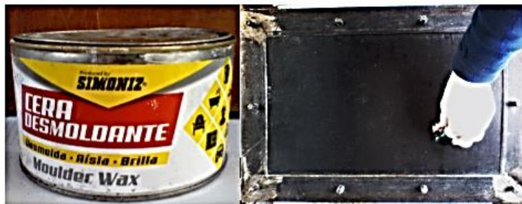
Figura 3. 9. Aplicación de una capa de cera desmoldante. Fuente: El autor
