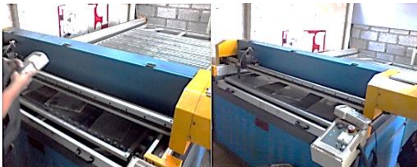
Figura 3. 19. Proceso de cortado de las probetas en una máquina láser.
