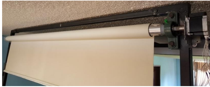
Figura 4.22: Acoplamiento del motor a pasos en la estructura de la persiana.
