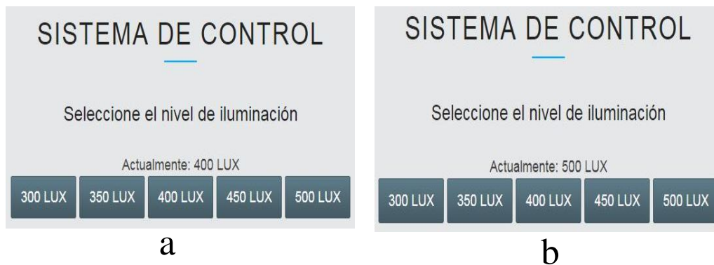
Figura 4.30: Niveles de iluminación en la plataforma.
