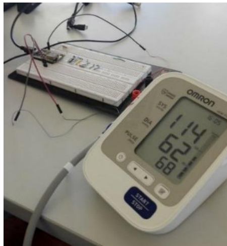
Fig. 4. 8 Conexión tensiómetro OMRON con NodeMCU
