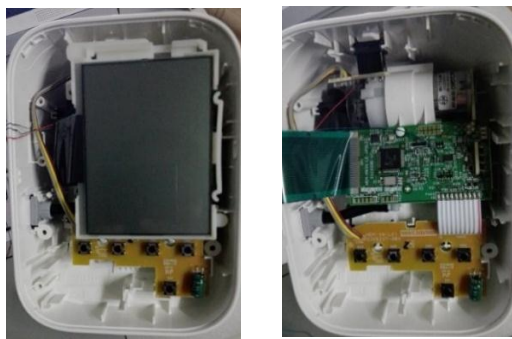
Fig. 4. 5 Parte interna de la placa central del tensiómetro
