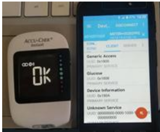
Fig. 5. 8 Conexión del glucómetro y el celular vía Bluetooth
