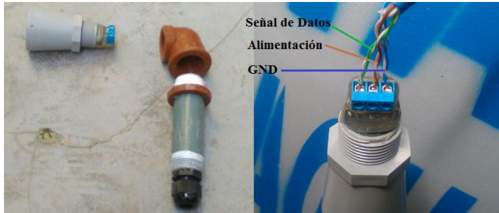
Figura 4. 33: Conexión del sensor ultrasónico.
