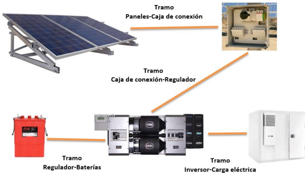
Ilustración 23. Tramos de cableado del sistema
