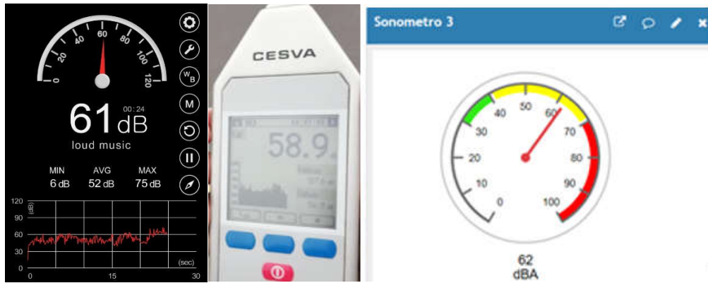
Fig. 4.43 Primer Valor Dispositivo Celular (Izquierdo), Sonómetro (Centro), Prototipo (Derecho) Fuente: Investigador
