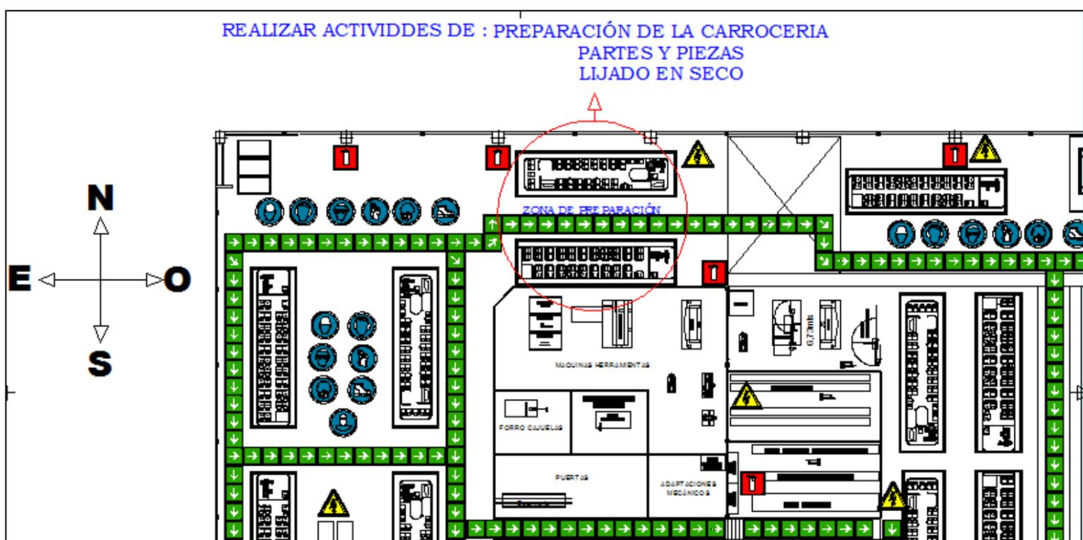
**Figura N. 65:** Layout propuesto con focos de contaminación ubicados en zona de preparación
