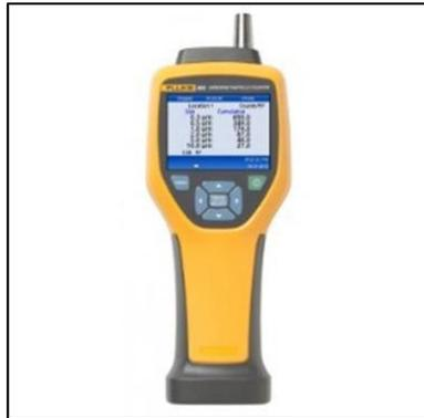
**Figura N. 32:** Medidor de concentración de partículas
