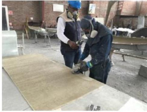
**Figura N. 40:** Medición material particulado – planchas del techo
