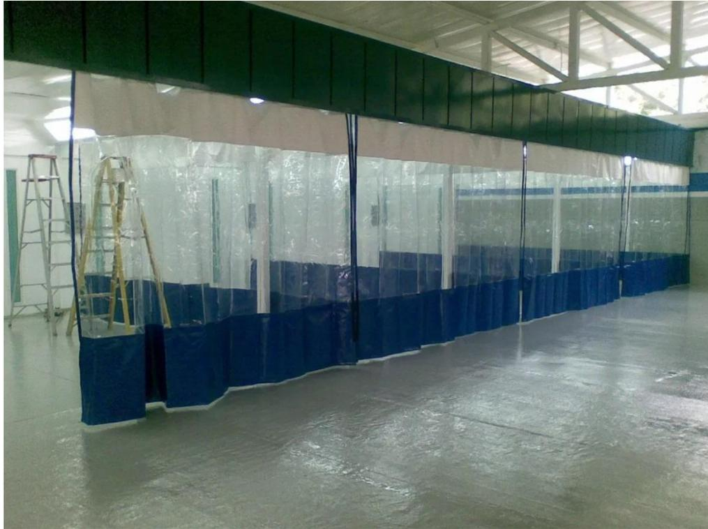
**Figura N. 62:** Cortinas de aislamiento para zonas de preparación
