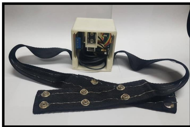
Fig. 55 Collar del nodo localizador vista interna Elaborado por la investigadora
