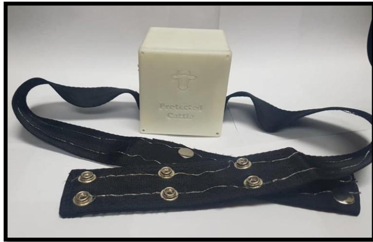
Fig. 54 Collar del nodo localizador vista externa Elaborado por la investigadora
