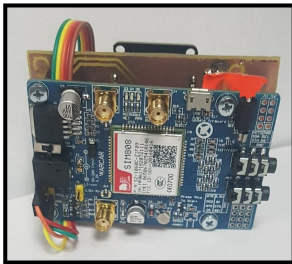
Fig. 31 Placa del Nodo Localizador Elaborado por Investigadora
