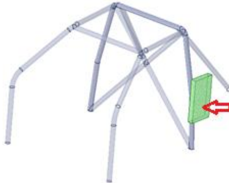
Figura 26 Carga lateral sobre arco principal
