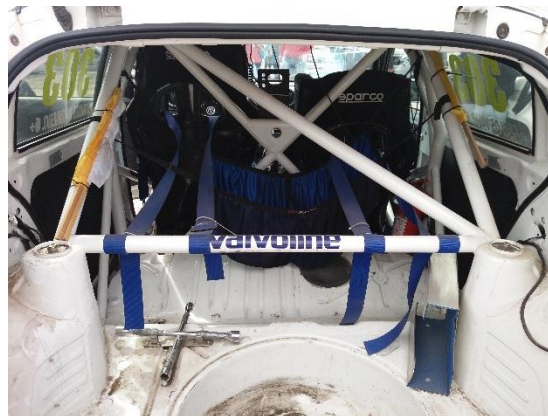
Figura 9 Arco posterior Roll bar homologado MM
