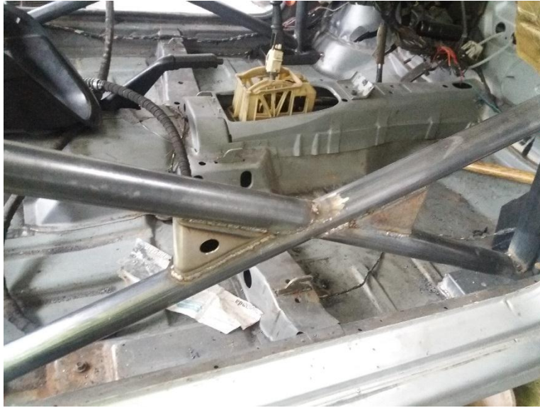
Figura 101 Placas perforadas para eliminar tensión y mejorar la estética
