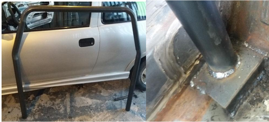
Figura 94 Corte doblaje e instalación del arco principal
