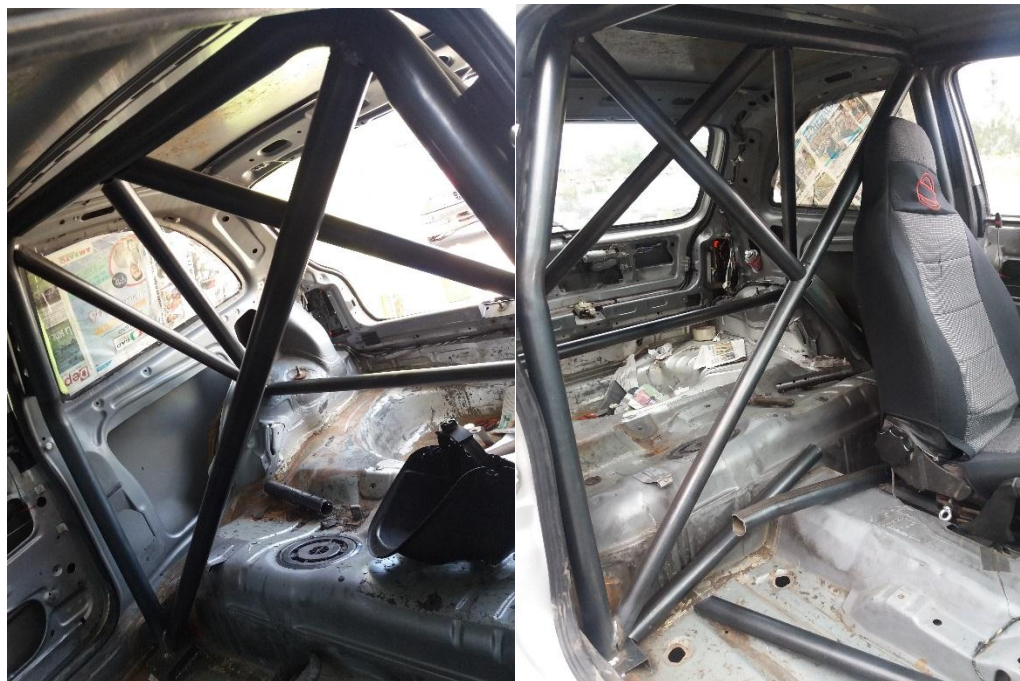
Figura 98 Instalación de tirantes en X en arco principal
