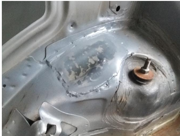
Figura 91 Refuerzos en zonas débiles de carrocería
