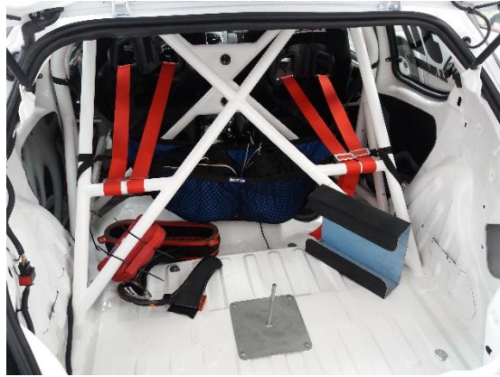
Figura 12 Roll bar homologado Sparco Peugeot 206 modalidad rally
