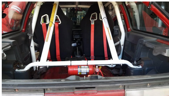
Figura 4 Roll bar artesanal Suzuki Forsa 2 modalidad trepada de montaña
