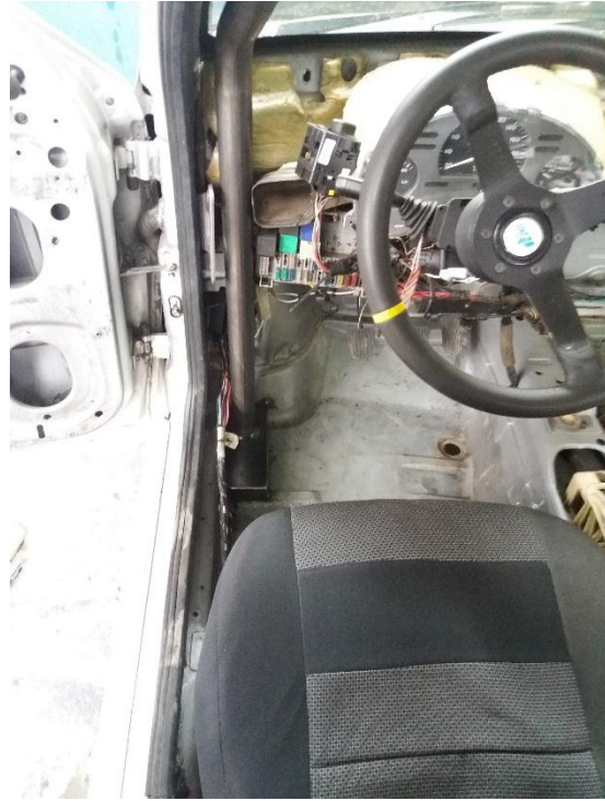
Figura 99 Instalación del arco delantero
