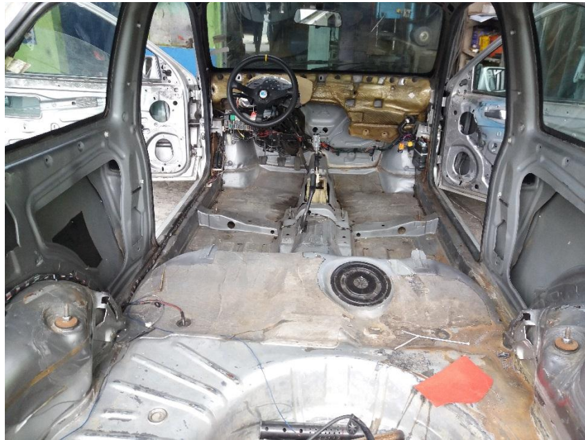
Figura 89 Limpieza y remoción de cableado y protecciones de carrocería
