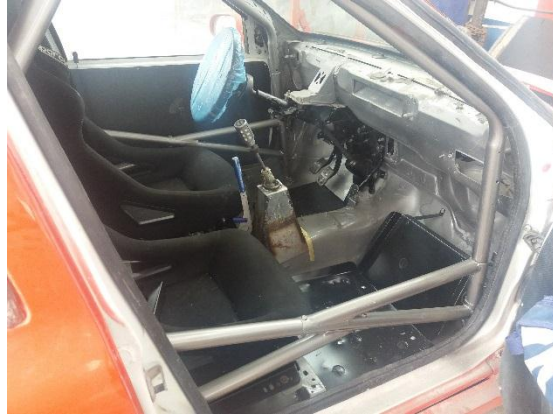
Figura 10 Arco frontal de Roll bar MM
