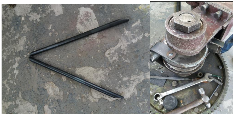
Figura 93 Corte y doblaje de tubería
