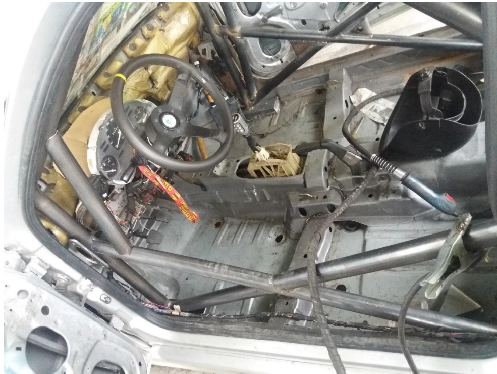
Figura 100 Tirantes en X para las puertas y soporte del arco delantero
