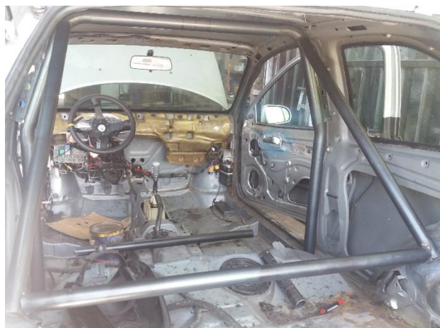
Figura 96 Instalación del arco trasero
