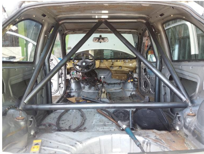
Figura 97 Instalación de tirantes en V en arco trasero
