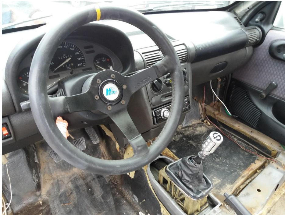
Figura 88 Remoción del interior del vehículo
